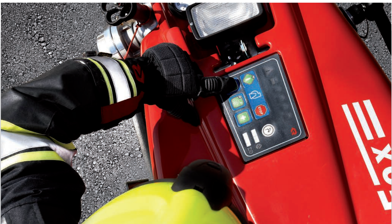
Bedienpanel im Betrieb mit Warnlampen, Drehzahl- und Betriebsstundenanzeige
